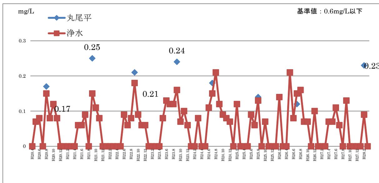
図-3 浄水の塩素酸濃度の推移
