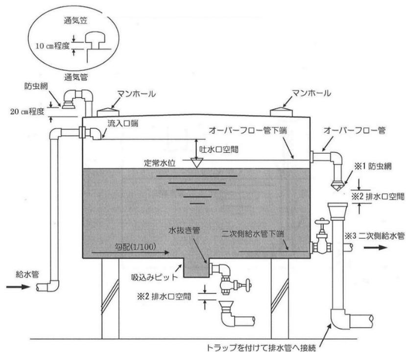
※1 防虫網の大きさに開口している面積は、オーバーフロー管の断面積以上であること。
